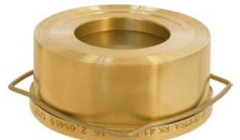
RK 41 mit Spiralzentrierung PN 6 bis PN 16, Gehäusewerkstoff: Sondermessing, Ventilteller: austenitischer Stahl
