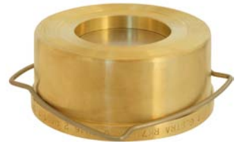
RK 71 mit Spiralzentrierung PN 6 bis PN 16, Gehäusewerkstoff: Pressmessing, Ventilteller: austenitischer Stahl
